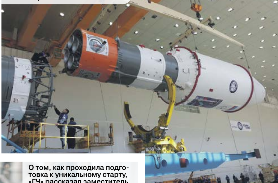
Монтаж головной части третьей ступени ракеты-носителя «Союз-2.1а» с воронежским двигателем
