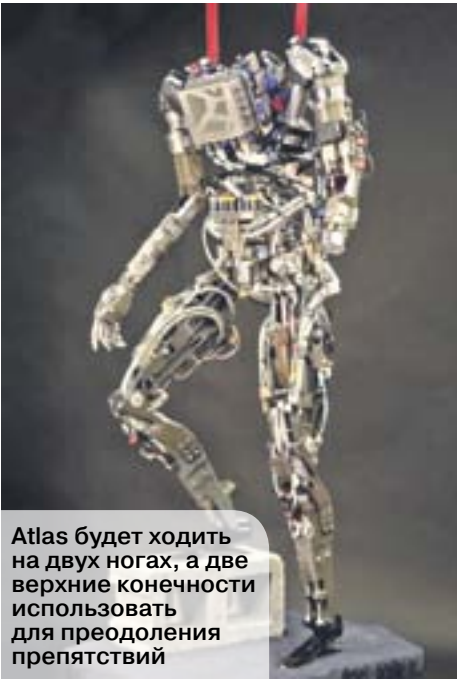
Atlas будет ходить на двух ногах, а две верхние конечности использовать для преодоления препятствий
